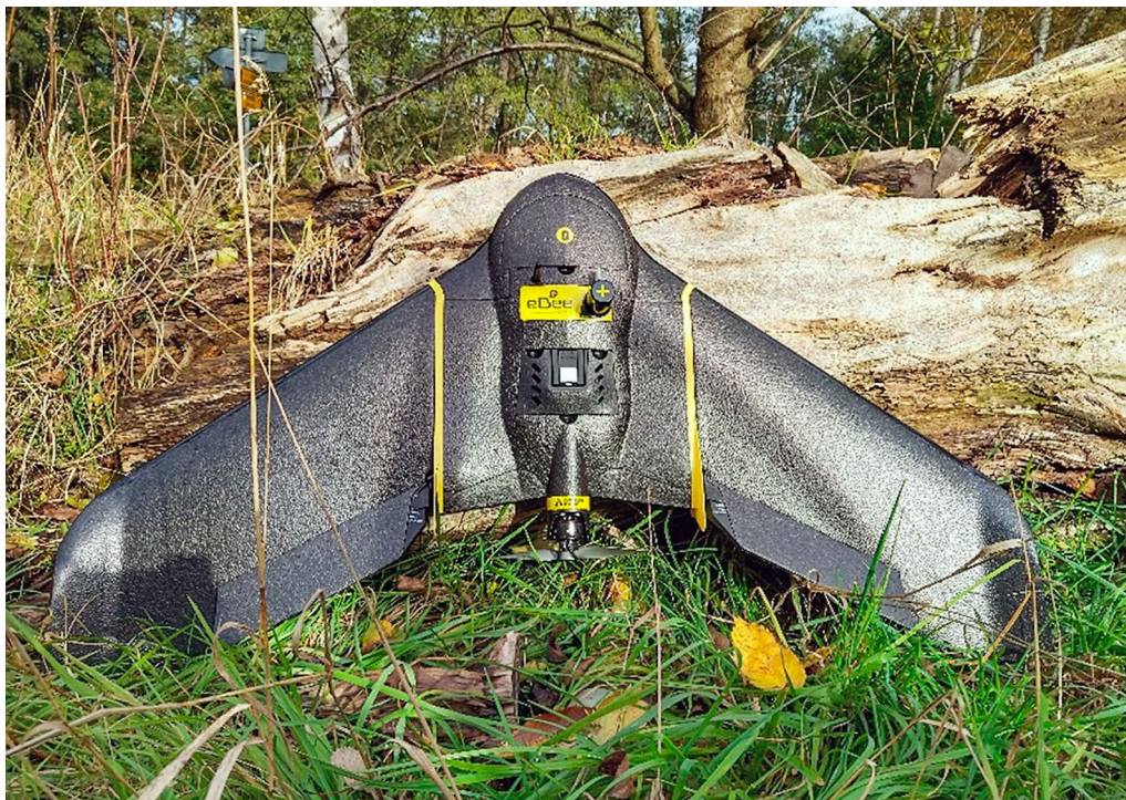
Obr. 3 Bezpilotní letoun senseFly eBee X
